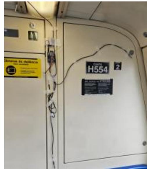
Os sistemas de aquisição de dados foram divididos pelo carro em três zonas de coleta diferentes para que validasse os gradientes de temperatura do trem em operação. Abaixo é possível observar o gradiente de temperatura do percurso Itaquera - Barra Funda.
